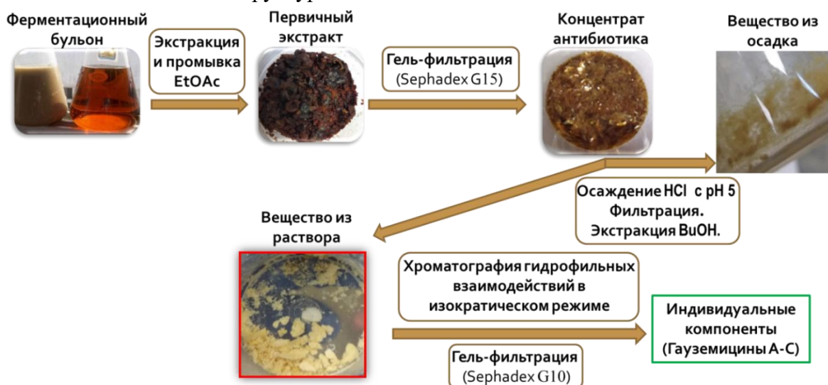
Рисунок 1 – Технология выделения индивидуальных компонентов антибиотического комплекса гауземицина.
