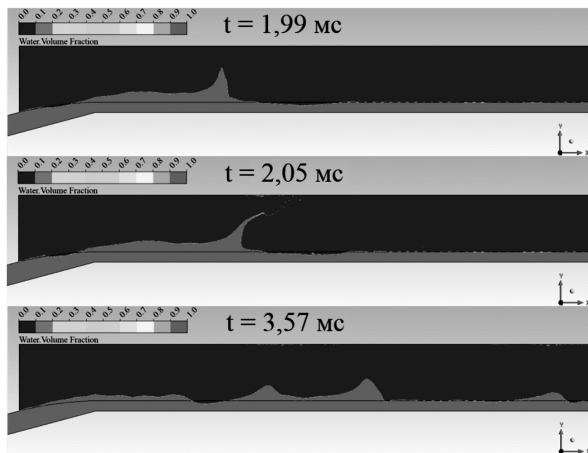
Рис. 2. Результаты расчета для входного участка с углом подвода жидкости 15^\circ . Скорость газа 25 м/с, скорость жидкости 1 м/с
