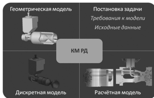
Рис. 1. Структура компьютерной модели ракетного двигателя
