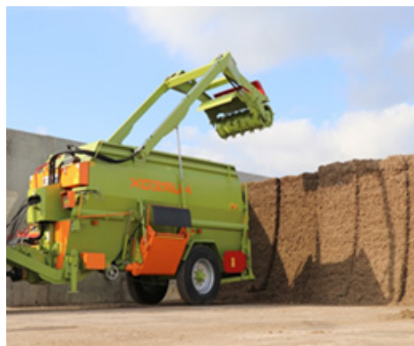
Рис. 17. Фрезерный погрузчик «Хозяин» и техника, режущая на блоки «JCB»
