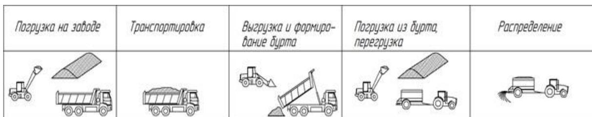
Рисунок 3 Перевалочная схема внесения дефеката
