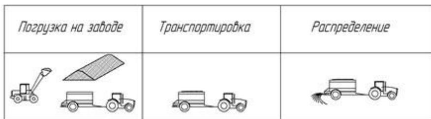
Рисунок 1. Прямоточная схема внесения дефеката
